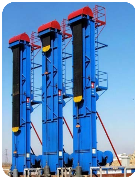
Unidade de bombeamento da torre
